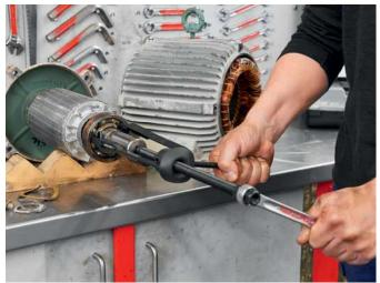
Der Twin Puller TP 150 schafft's: Ein festsitzendes Lager eines Elektromotors wird ohne Beschädigung der Welle demontiert.
