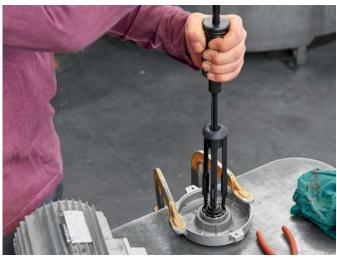
Speditive Demontage eines Lagers aus einem Elektromotor-Deckelgehäuse mit dem Maintenance Kit MK 10–30.
