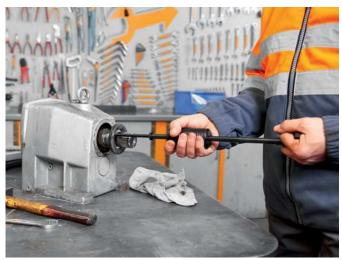
Gewusst wie: Ausbau einer Wellendichtung an einem Getriebe mit dem simatool Seal Puller SP 50.
