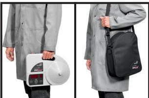
Das tragbare simatherm Induktions-Anwärmgerät für Wälzlager und andere ringförmige Eisenmetallteile ab 20 mm Innen- und bis 160 mm Aussendurchmesser. Mit der Zeit- und Temperaturautomatik lassen sich Wälzlager auf die von Herstellern vorgeschriebenen 110°C bzw. andere ringförmige Eisenmetallteile bis 180°C aufwärmen.
