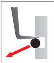
**Winkelhebel-Werkzeug**, entfernt O-Ringe durch Hebelwirkung aus normal oder schwer zugänglichen Einbauräumen.
