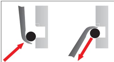
**Abziehhebel-Werkzeug**, entfernt O-Ringe oder positioniert sie.
