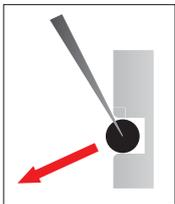
**Stech-Werkzeug**, entfernt O-Ringe aus normal oder schwer zugänglichen Einbauräumen. Der O-Ring kann dadurch nicht mehr wiederverwendet werden
