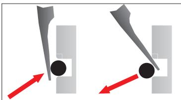
**Flach-Werkzeug**, entfernt oder positioniert O-Ringe, die leicht zugänglich sind. Kombinierbar mit anderen Werkzeugen.
