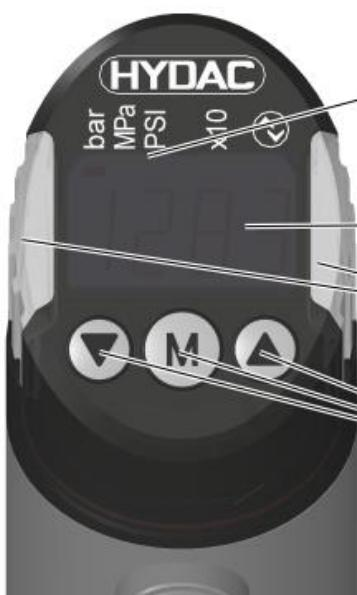
Anzeige-LEDs für Einheit, Faktor, Kommunikation
