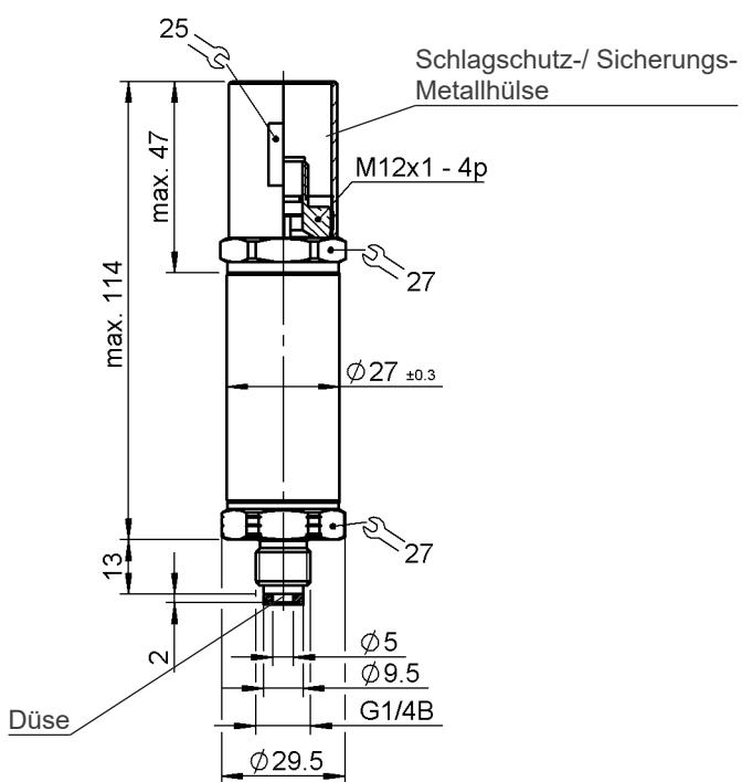
Die Schlagschutz-/Sicherungsmetallhülse ist im Lieferumfang enthalten. Für den elektrischen Anschluss ist eine gerade Kupplungsdoze erforderlich. Z.B. Kupplungsdoze M12x1, 4-pol., gerade mit 3 m Leitung, geschirmt: ZBE06S-03, Mat. Nr. 6098243
