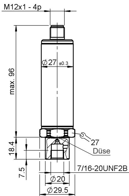
Ausführung in Zündschutzart „Nicht funkend“ (Ex nA), mit Schlagschutz-/Sicherungsmetallhülse
