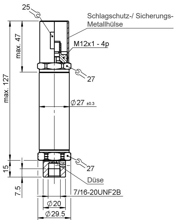
Die Schlagschutz-/Sicherungsmetallhülse ist im Lieferumfang enthalten. Für den elektrischen Anschluss ist eine gerade Kupplungs-dose im Lieferumfang enthalten. Z.B. Kupplungsdoze M12x1, 4-pol., gerade mit 3 m Leitung, geschirmt: ZBE06S-03, Mat. Nr. 6098243
