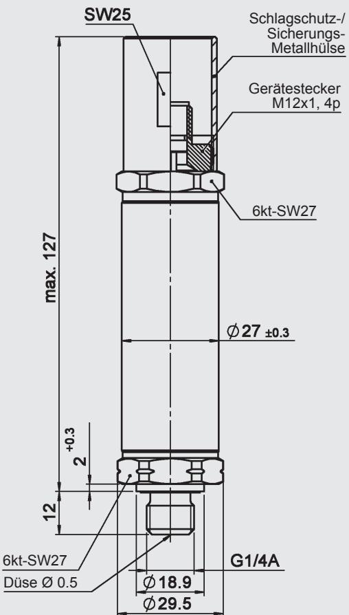
Die Schlagschutz-/ Sicherungsmetallhülse ist im Lieferumfang enthalten. Für den elektrischen Anschluss ist eine gerade Kupplungsdoze erforderlich. Z.B. Kupplungsdoze M12x1, 4-pol, gerade mit 3m Leitung geschirmt: ZBE 06S-03, Mat. Nr. 6098243
