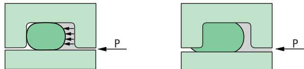
Die in der Tabelle aufgeführten Richtwerte der Spaltmaße für Standardelastomere stellen bei zentrischer Anordnung der Bauteile Maximalwerte dar. Die zulässigen Werte für den Dichtspalt sind vom Druck, der Werkstoffhärte und dem Durchmesser abhängig. Sämtliche Angaben beruhen auf Erfahrungswerten und sind lediglich als Richtwerte zu betrachten.
