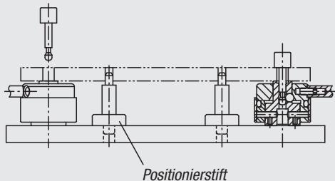
Gleichzeitiges Spannen und Positionieren eines Werkstücks
