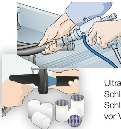
leitung mit einem Reinigungs- und Korrosionsschutzmittel und bläst sie dann mit Druckluft aus. Die Trockenreinigungssysteme TH6-10-EL-8 oder TH6-10-HL-10-2 schießen ein Ultra Clean Projektil komplett durch den Schlauch. Schützen Sie zum Schluss die Schlauchleitung mit Plastikstopfen vor Verschmutzung.
