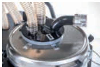
Bedieneinheit der Schubumkehr zur Behälterentleerung (Flüssigkeiten).
