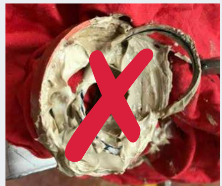
Da keine Nachschmierung erforderlich ist, sammelt sich kein überschüssiges Fett in den Enddeckeln an.
